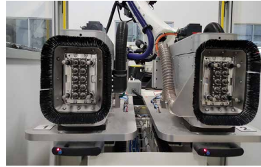
► Changement automatique de l'effecteur pour un remplacement manuel des forets en temps masqué
