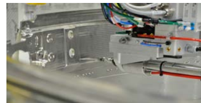
Chanfreinage sortie usinage de l'ensemble des arêtes et alésages.
