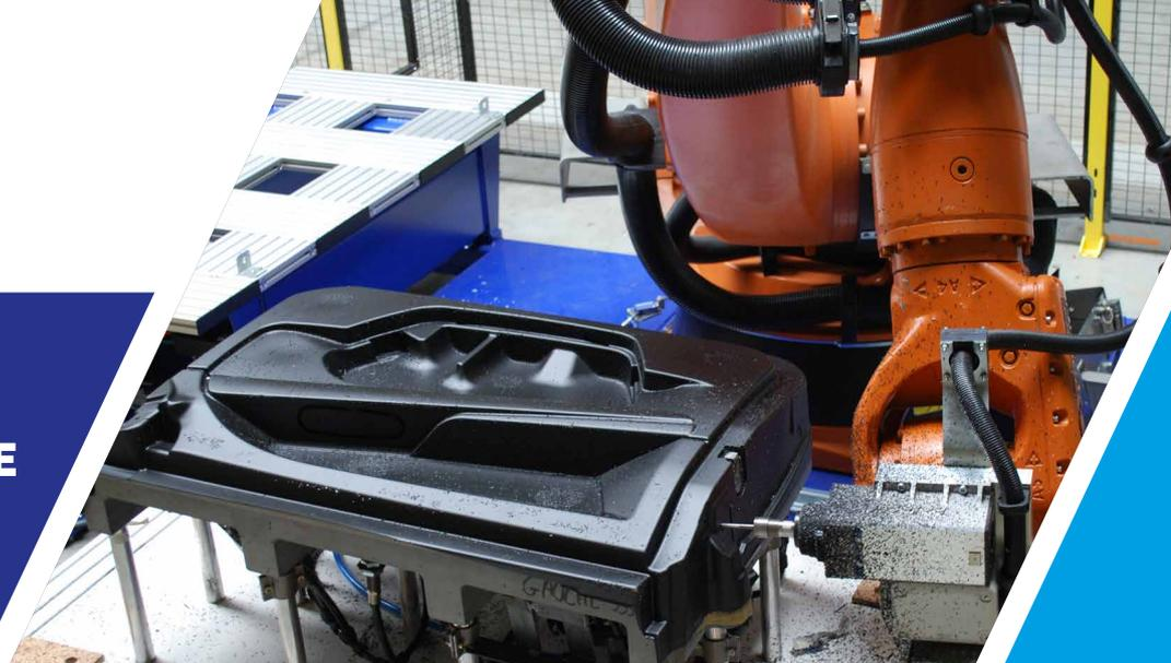
Le détournage est, de nos jours, une opération très répandue dans la production de pièces. Les exigences de précision, les cadences de production, ainsi que la complexité des pièces imposent une automatisation de ces procédés.
