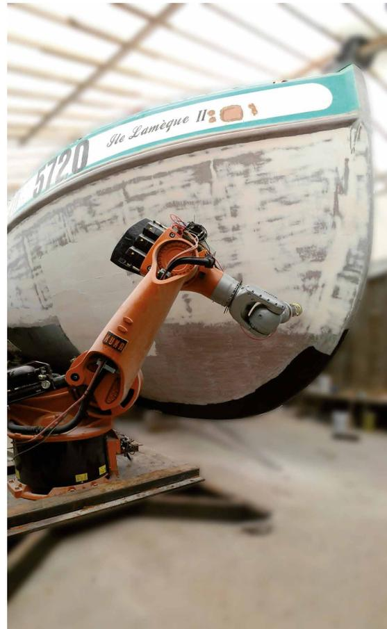
Ponçage robotisé sur coque de bateau
